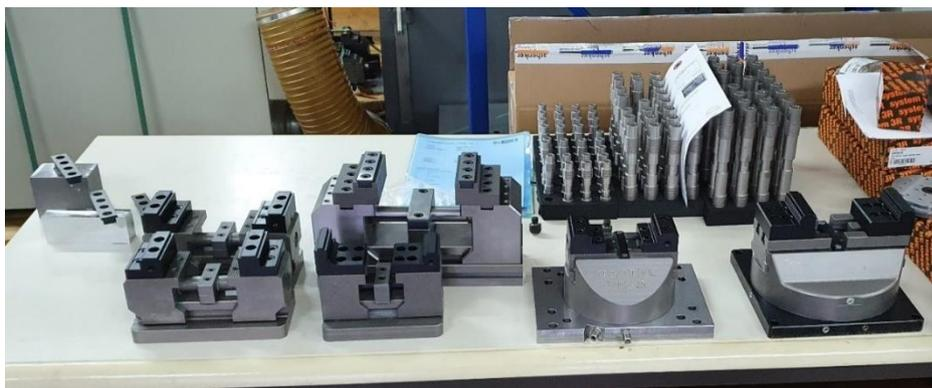
Abb. 7 – verschiedene Zentrumspanner mit dem Spannbacken-Bauklotzsystem
